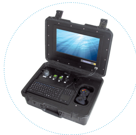
TMI-Orion Dynamics Surface Control Unit
